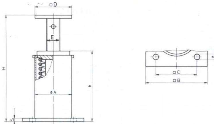
Federstützen-Konstruktion mit Grundplatte; Gewinderohr in der Höhe verstellbar.
